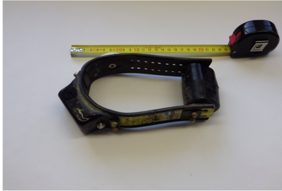
Abbildung 3: Eingesetzte Telemetrietechnik. Ein VECTRONIC-Senderhalsband der Serie GPS PLUS. Foto: IZW Berlin.
